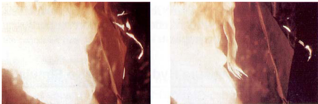
图3 • 各种不同的液压液喷射燃烧性测试
